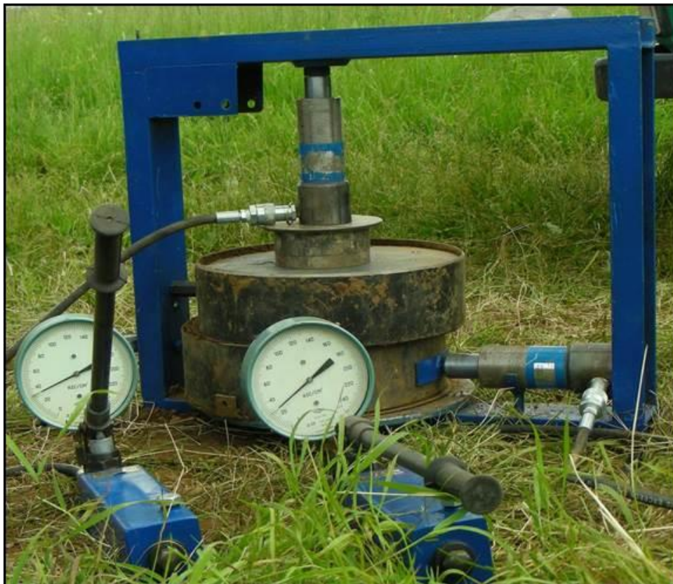
Рисунок 23 - Установка MSU-2 для среза целика грунта
