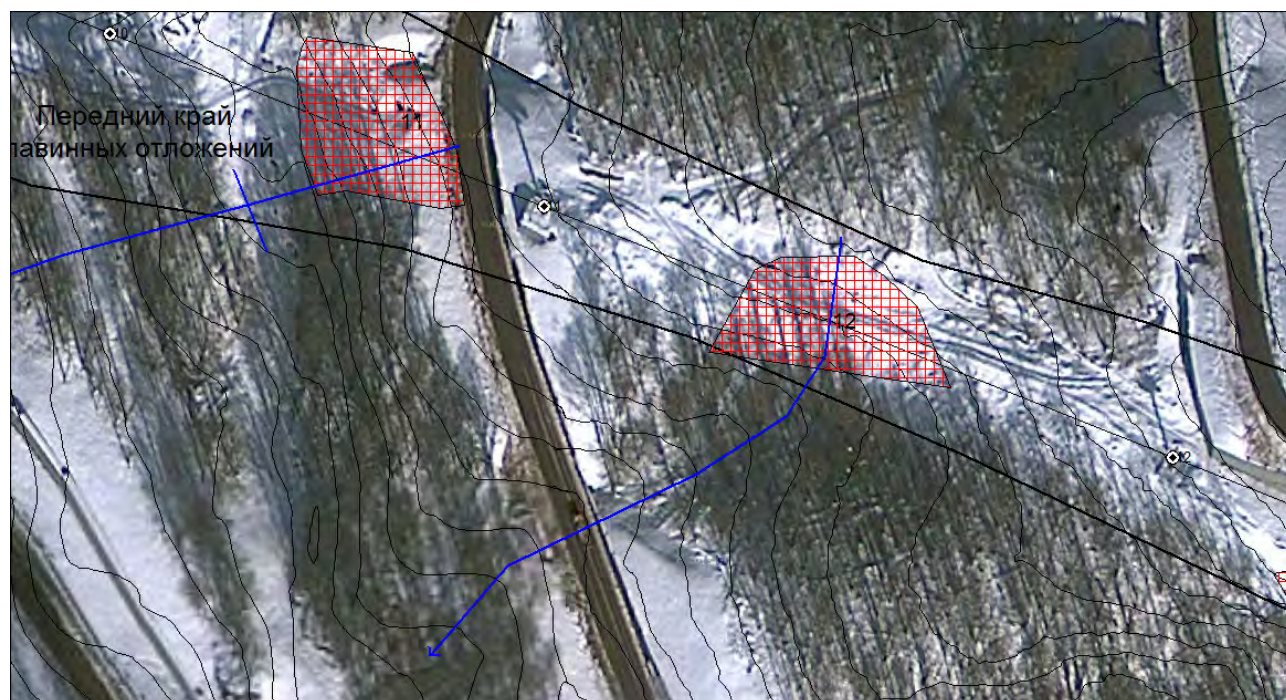
Рис. 6.62. Расположение лавинного очага 12 между опорами 11 и 12 канатной дороги.
