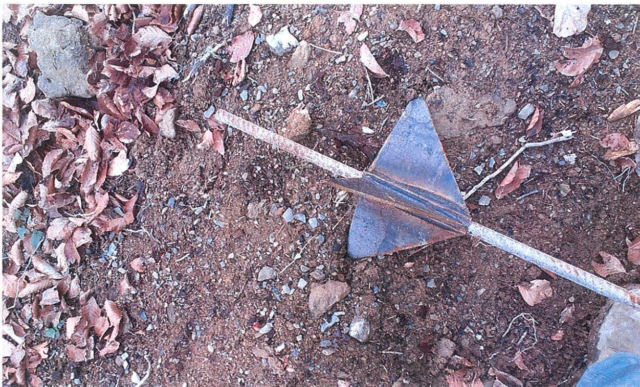
Рисунок 5. Конструкция оползневого репера
