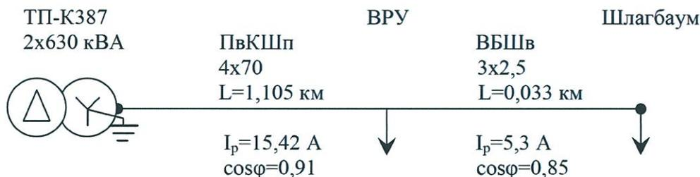
**Рисунок 1** Схема кабельной линии 0,4 кВ «ТП-К387 – ВРУ»
